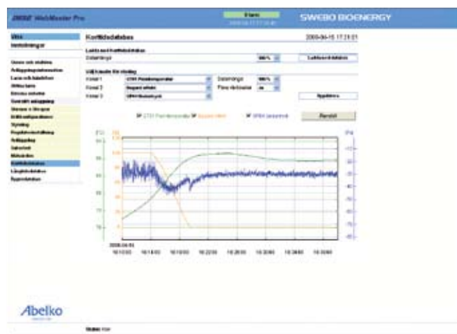
Bild 2 och 3. Ex. på gränssnitt för styrning av anläggning.
